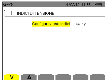
Figura 27: lo schermo Indici di tensione nel menu Sensore e indici in caso di un montaggio con neutro
