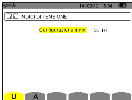
Figura 26: lo schermo Indici di tensione nel menu Sensore e indici in caso di un montaggio senza neutro
