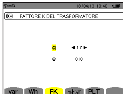
Figura 22: il menu selezione dei coefficienti di calcolo del fattore K
