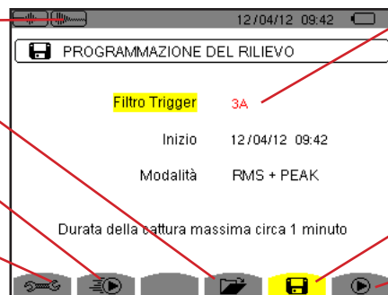
Figura 42: lo schermo Programmazione della cattura in modo Corrente di chiamata
